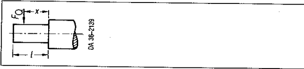
Bild 7/8 Angriffspunkt von Querkraften an Wellenenden von Motoren
