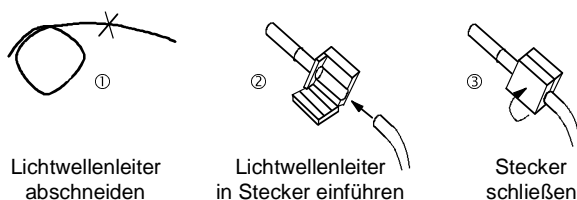
Bild 5-4 Kabel anschließen
