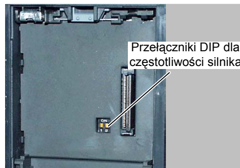
Rys. 3-4 Przełączniki DIP do wyboru częstotliwości silnika
