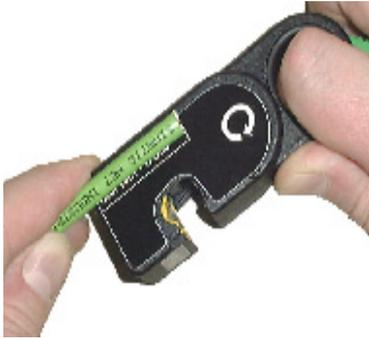
Abmessen der abzuisolierenden Leitungslänge durch Anlegen der Leitung an der Maßschablone. Anschlag mit dem Zeigefinger der linken Hand.
