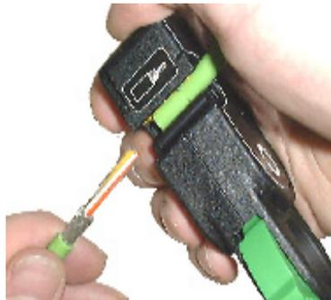
Abisolierwerkzeug im geschlossenen Zustand vom Leitungsende abziehen.
