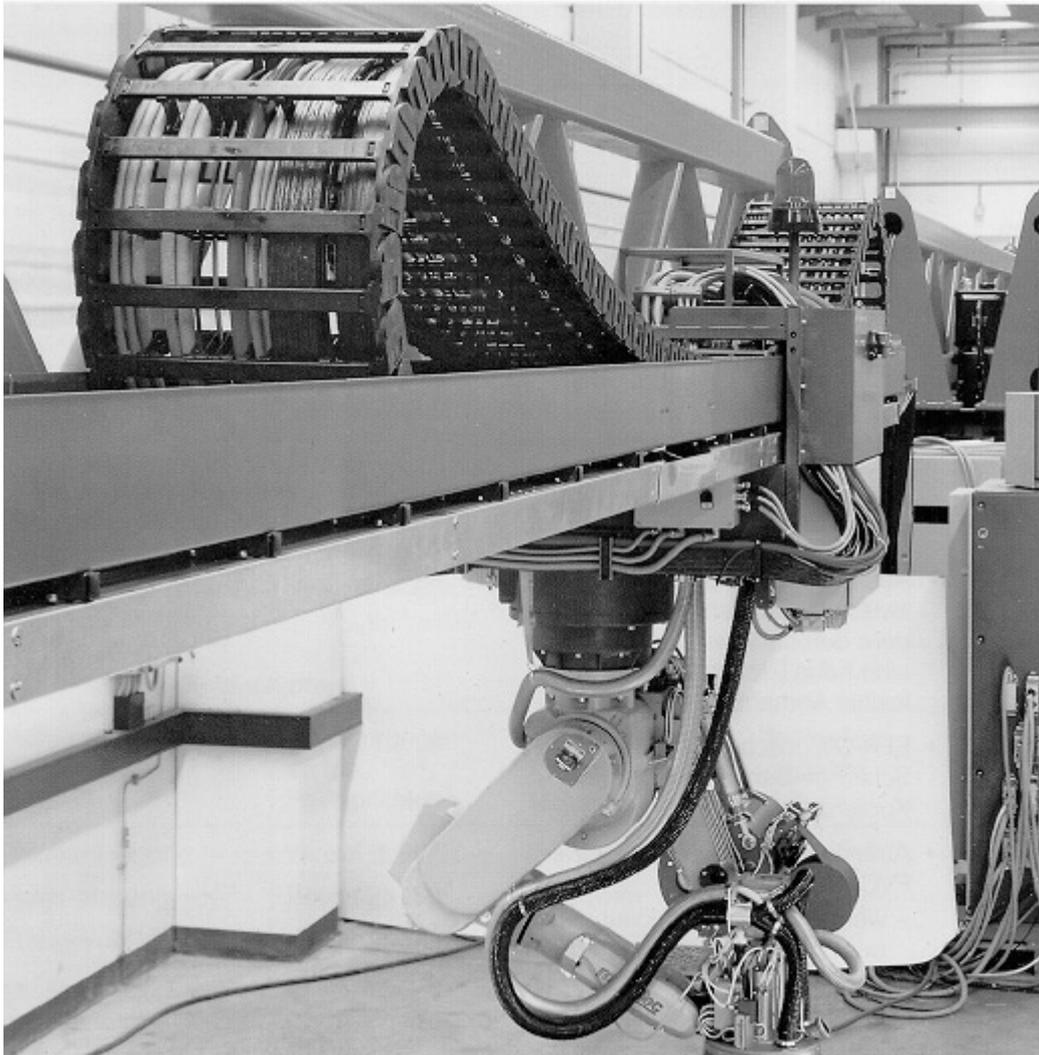
Bild 5-4 Einsatzbeispiel Glas-LWL Schleppleitung in einer Schleppkette
