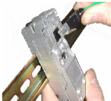
Anschluss des Endgeräts oder der Netzkomponente über entsprechende RJ45 Patchleitung.
