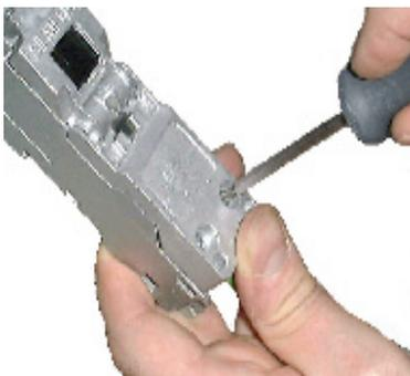
Gehäusedeckel des FC Outlet RJ45 schließen und verschrauben.
