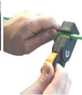
Leitungsende im Abisolierwerkzeug bis zum Anschlag festspannen.
