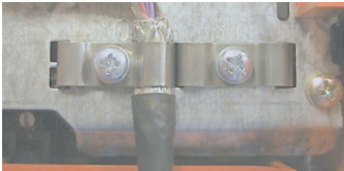
01937AXX Rysunek 17: Ekran przyłączyć do zacisku ekranowego elektroniki przetwornicy
