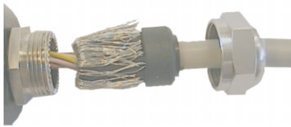
01948AXX Rysunek 18: Ekran przyłączyć do połączenia gwintowego PG nadajnika
