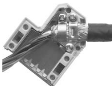
Rys. 30: Przymocowanie ekranu we wtyczce Sub-D
