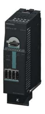
DS1E-X FOR ET200S HIGH FEATURE DIRECT STARTER SETTING RANGE 0.3...3A MECHANICAL SWITCHING ELEKTRONIC CONTACTOR AC-3/TO 1.1KW/400V EXPANDABLE FOR BRAKE CONTROL MODULE 2DI MODULE MOTORSTARTER ES SIGNAL FROM CIRCUIT-BREAKER PARAMETERIZABLE
