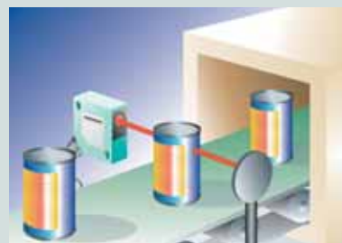
Zliczanie z wykorzystaniem czujnika odblaskowego z lustrem
