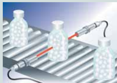
Zliczanie z wykorzystaniem czujnika-bariery
