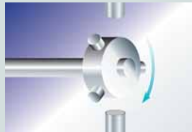
Rozpoznawanie elementów kół zębatach w celu kontroli prędkości lub kierunku
