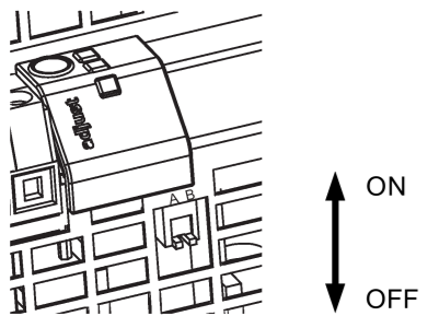
Bild 6: Wahlschalter Image 6: Selector switch Figura 6: Selector 图 6: 选择开关 Figure 6: Sélecteur Figura 6: Selettore Рисунок 6: Селекторный переключатель
